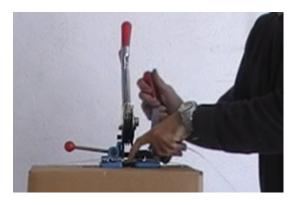
Accionaremos la palanca de vaivén hasta tensar el fleje.
