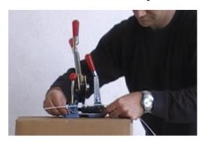
Situaremos la parte final del fleje bajo la placa de sujeción de la flejadora.
